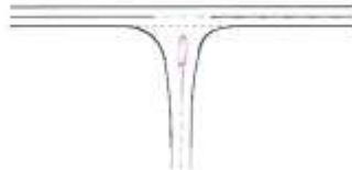
Εικόνα 4.2: Τύπος Α2 Ισόπεδου Κόμβου Πηγή: Οδηγός Μελέτων Οδικών Έργων – Ισόπεδοι Κόμβοι (ΟΜΟΕ-Κ) – 2011
