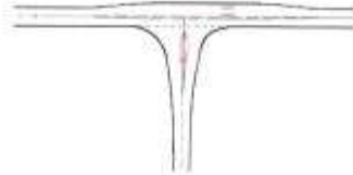
Εικόνα 4.3: Τύπος Α3 Ισοπέδου Κόμβου (Πηγή: Οδηγός Μελετών Οδικών Έργων – Ισοπέδοι Κόμβοι (DMOE-Κ) – 2011)
